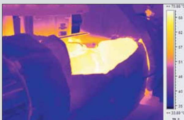
På termografiske foto kan man tydeligt se det reducerede varmetab ved anvendelsen af ISOCARE.
