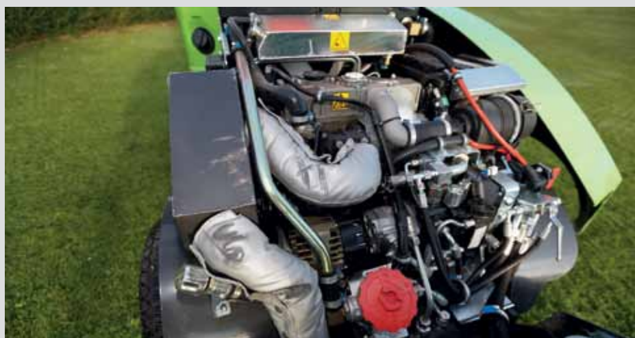
Motor-isolering af udstødning og varme rør.
