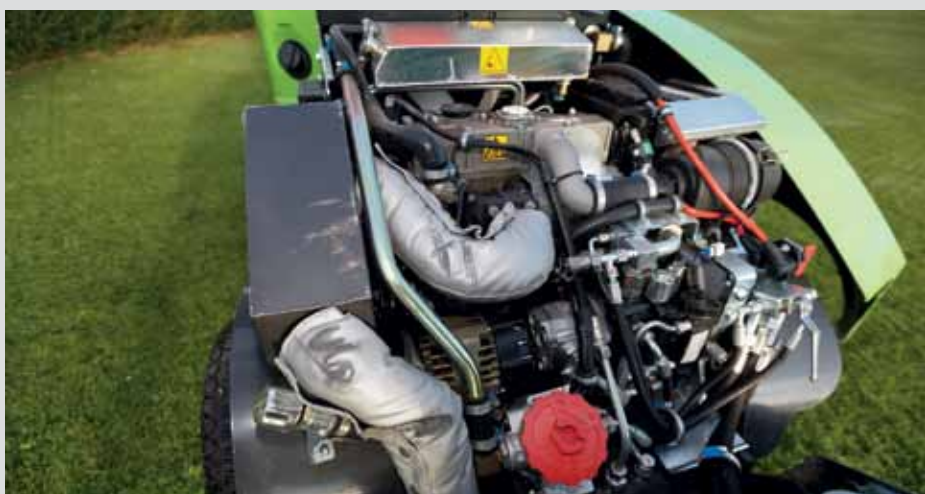
Motor-isolering af udstødning og varme rør.
